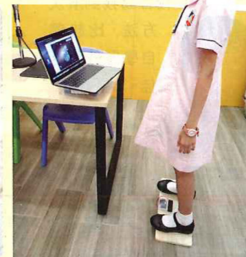
將micro:bit安裝於踏板下，就可控制Scratch內遊戲練習專注力。
